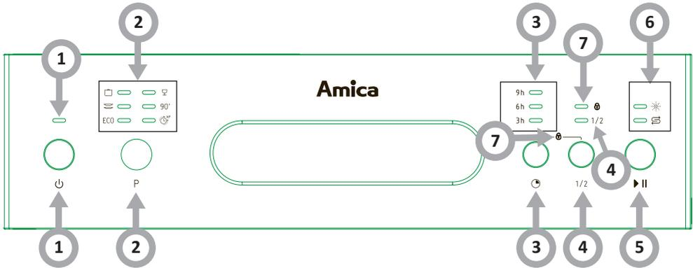
1. Betriebstaste und -anzeige: sie dient zum Einschalten des Gerätes; sie leuchtet nach dem Einschalten auf.
