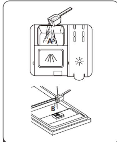
2. Füllen Sie das größere Fach (A) für den Hauptspülgang mit Spülmittel. Für optimale Spülergebnisse, besonders bei stark verschmutztem Geschirr, können Sie etwas Spülmittel auf die Tür geben. Dieses zusätzliche Spülmittel kommt beim Vorspülen zum Einsatz.
