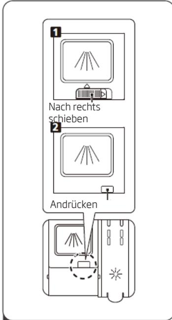
1. Öffnen Sie den Deckel, indem Sie den Riegel verschieben.
