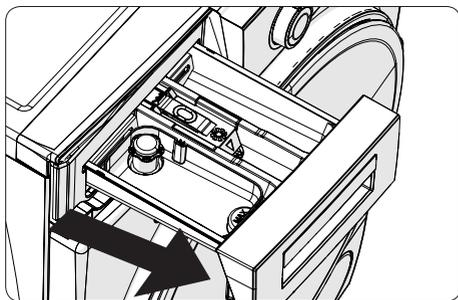
Appuyer à l'endroit indiqué sur l'image, à l'intérieur du compartiment à détergent et le tirer vers l'avant.
