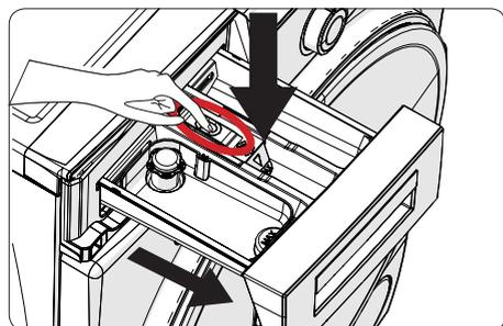
Retirer le compartiment et démonter le verrouillage de rinçage. Nettoyer soigneusement et éliminer tous les dépôts. Fixer le verrouillage de rinçage après son nettoyage et s'assurer qu'il est correctement placé.
