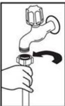
Verwenden Sie den Zulaufschlauch vom alten Geschirrspüler nicht. Verwenden Sie den neuen Zulaufschlauch, der zusammen mit dem Gerät geliefert wurde. Vor dem Anschließen spülen Sie den Zulaufschlauch von Innen mit Wasser aus. Schließen Sie den Zulaufschlauch direkt an einen Wasserhahn an. Der Wasserdruck in der Versorgungsanlage sollte mindestens 0,04 MPa und maximal 1 MPa betragen. Wenn der Wasserdruck 1 MPa übersteigt, muss vor dem Geschirrspüler ein Druckminderventil eingebaut werden.
