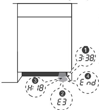
1. Die Signalleuchte zeigt bei geschlossener Tür die verbleibende Zeit 1 oder den Fehlercode 2 oder den Verzögerungszustand 3 an.
