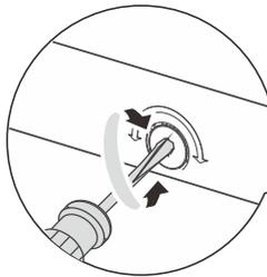
Drehen Sie den Schraubenzieher im Uhrzeigersinn, um die Höhe zu erhöhen, und drehen Sie ihn gegen den Uhrzeigersinn, um die Höhe zu verringern.
