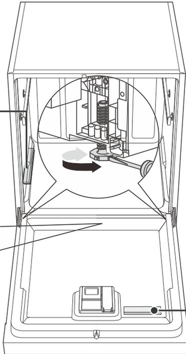
Drehen Sie den Schraubendreher nach links, um die Höhe zu erhöhen, und nach rechts, um die Höhe zu verringern.
