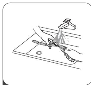
1. Pour démonter le bras d'aspersion supérieur, maintenir l'écrou en place et tourner le bras à gauche.
