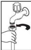
Ne pas utiliser le tuyau d'alimentation en eau de l'ancien lave-vaisselle. Utiliser le nouveau tuyau d'alimentation fourni avec l'appareil. Avant de raccorder le tuyau, le rincer de l'intérieur avec de l'eau. Raccorder le tuyau d'alimentation en eau directement au robinet d'arrivée d'eau. La pression de l'eau dans l'installation devrait être de 0,03 MPa au minimum, et de 1 Ma au maximum. Si la pression de l'eau dépasse 1 MPa, il est nécessaire d'installer un réducteur de pression.
