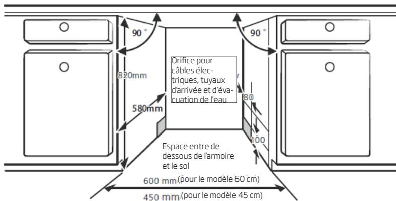
2. En installant le lave-vaisselle dans une armoire angulaire, laisser de la place pour l'ouverture de la porte.
