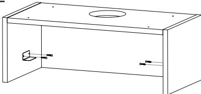
Vinkelbeslagene til klikkmontering skal plasseres og skrues på høyre og venstre side, så de passer med opphengsmekanismen på siden av ventilatoren.(Fig.3.4).
