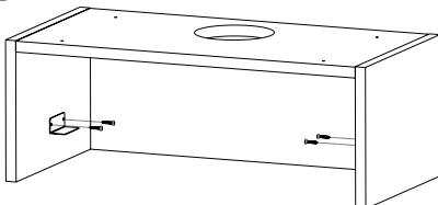
Vinkelfästarna för klickmontering ska placeras och skruvas fast på höger och vänster sida för att passa med fjädringsmekanismen på kåpan. (Fig.3.4).
