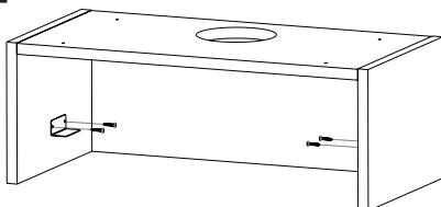
Kulmaraudat ruuvataan kiinni sivuilla oleviin kalustoseen (oikealle ja vasemmalle puolelle) siten, että ne sopivat liesituulettimen sivuilla oleviin kulmattiimiin (Kuva 3.4).
