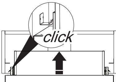
Skjut nu upp fläktkåpan i skåpet så att den klickar fast med hjälp av upphängningsmekanismen på vinkelbeslaglen till klickmontering. (Fig 3.5).
