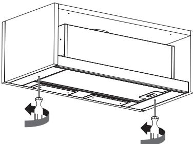
Använd en skravmejsel för att sätta fast fläktkåpan i skåpet. Detta ska göras nedifrån med hjälp av upphängningsmekanismen (Fig. 3.6).
