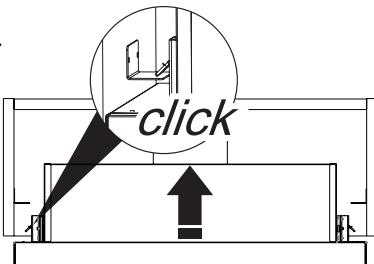
Skjyv viften opp i skapet slik at den klikker seg fast ved hjelp av opphengsmekanismen på vinkelbeslagene til klikkmontering. (Fig. 3.5).
