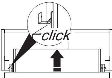
Työnnä liesituuletin koteloon niin, että se napsahtaa paikoilleen kulmakiinnikkeissä olevalla ripustusmekanismilla (Kuva 3.5).
