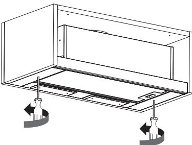
Kiinnitä liesituuletin kaappiin ruuvitallalla. Tämä tehdään alapuoleltä ripustusmekanismin avulla (Kuva 3.6).
