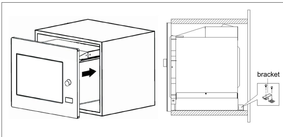
Die Tür öffnen, die Mikrowelle in der Montageöffnung an den Küchenschrank mit der Schraube B befestigen. Anschließend den Kunststoffschutz in der Montageöffnung befestigen.
