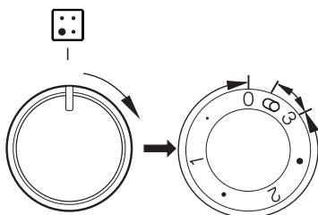
Bei einer Schalterstellung von „0 ● 1 ● 2 ● 3“ ist die innere Kochfläche in Betrieb und die Wärmemenge für das Kochgeschirr ist leicht regulierbar. Kurzes Drehen des Schalters auf die Position – schaltet die äußere Kochfläche ein. Ab jetzt lässt sich die Wärmemenge von beiden Kochflächen leicht regulieren, denn der innere Schalter wird beide Kochflächen erst nach Rückstellung des Reglers auf die 0-Position abschalten.
