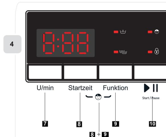
7. Taste für die Wahl der Schleudergeschwindigkeit (U/min)
