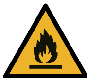
Danger; risque d'incendie/ matières inflammables
