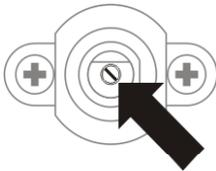
Die Kalibrierung der Hähne hat beim betriebenen Brenner in der Sparflammenstellung zu erfolgen, unter Zuhilfenahme eines Regelschraubendrehers der Größe 2,5 mm.
