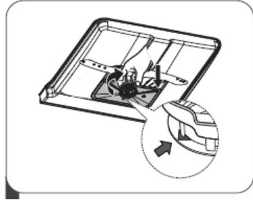
3. Größere Überreste können unter fließendem Wasser abgespült werden. Mit einem weichen, sauberen Tuch kann der Filter noch sorgfältiger gereinigt werden.
