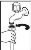
Verwenden Sie den Zulaufschlauch vom alten Geschirrspüler nicht. Verwenden Sie den neuen Zulaufschlauch, der zusammen mit dem Gerät geliefert wurde. Vor dem Anschließen spülen Sie den Zulaufschlauch von Innen mit Wasser aus. Schließen Sie den Zulaufschlauch direkt an einen Wasserhahn an. Der Wasserdruck in der Versorgungsanlage sollte mindestens 0,03 MPa und maximal 1 MPa betragen. Wenn der Wasserdruck 1 MPa übersteigt, muss vor dem Geschirrspüler ein Druckminderventil eingebaut werden.
