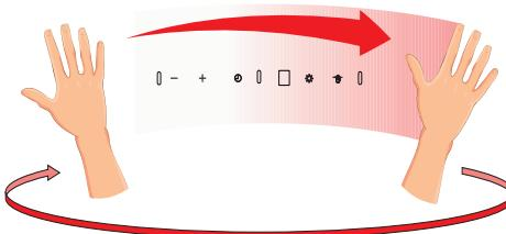
Voit kytkeä puhaltimen päälle tai lisätä puhallinnopeutta siirtämällä kätesi vasemmalta oikealle useita kertoja valmiustilassa. Näyttöön tulee kunkin käseleen jälkeen nykyinen puhallinnopeus.
