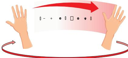
Tænd ventilatoren, eller øg ventilatorhastigheden ved at bevæge hånden fra venstre til højre flere gange i standby-tilstand. Displayet vil vise den aktuelle ventilatorhastighed efter hver håndbevægelse.
