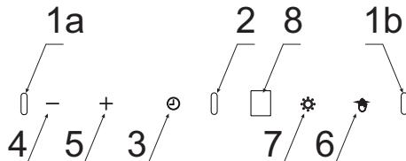
Apparatet er udstyret med bevægelsessensorer (1a, 1b, 2) og et display (8).
