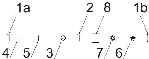
Laitteessa on eleohjausanturit (1a, 1b, 2) ja näyttö (8).
