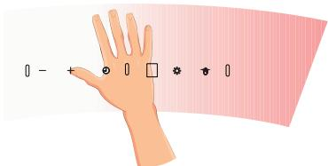
För att tända eller släcka belysningen håller du handen stilla cirka 10 cm ovanför sensor 2.
