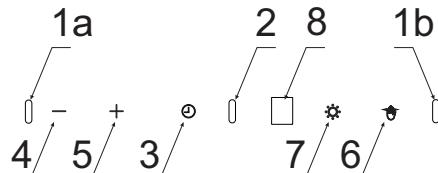
Apparatet er utstyrt med bevegelseskontrollsensorer (1a, 1b, 2) og et display (8).
