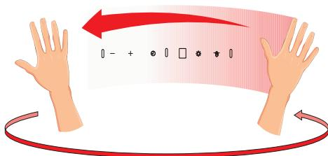
Sluk ventilatoren eller reducer ventilatorhastigheden ved at bevæge hænden fra højre til venstre flere gange i standby-tilstand, indtil displayet viser . Bevæg hånden en gang mere, og apparatet slukker (bevægelsesbetjening er stadig aktiv)
