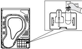
Mit einer Zange das Abflussrohr aus dem Verbindungsstück herausnehmen.
