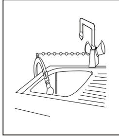
Normalerweise fließt das Kondenswasser in den Behälter in der oberen linken Ecke des Trockners. Optional können Sie einen Abflussschlauch (nicht im Lieferumfang enthalten) benutzen und an den Trockner anschließen. Schließen Sie den Schlauch wie hier gezeigt an.
