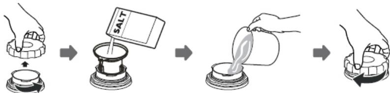
1. Nehmen Sie den unteren Korb aus dem Gerät und drehen Sie den Deckel des Behälters ab.
