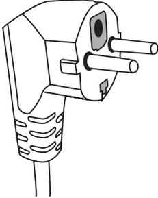
Das Gerät muss geerdet werden. Bei einem Kurzschluss verringert die Erdung die Gefahr eines elektrischen Schlags, indem die Ableitung von Strom gewährleistet wird. Das Gerät ist mit einem Netzkabel mit Erdungsleitung mit einem entsprechenden Stecker ausgestattet. Der Stecker soll in eine ordnungsgemäß installierte und geerdete Steckdose gesteckt werden.
