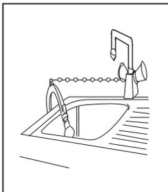
Dans la version standard le sèche-linge évacue l'eau condensé dans le récipient qui se trouve dans le coin supérieur gauche du sèche-linge. En option, il est possible de connecter au sèche-linge un tuyau de vidange qui se trouve dans le sac d'accessoires. Connecter le tuyau comme indiqué sur la figure à côté.
