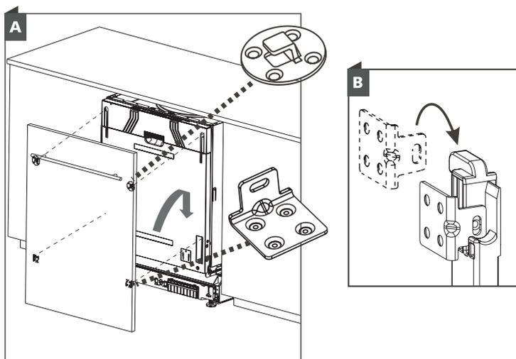
Nach dem Festziehen der Schrauben sollten zwei Gummistopfen in die Löcher gesteckt werden, um ein Einklemmen der Finger zu vermeiden.
