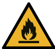
Danger; risque d'incendie/ matières inflammables
