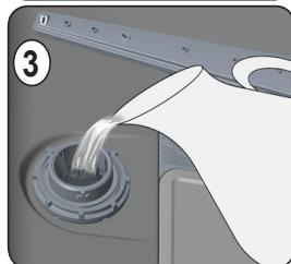
Bruk spesifikt salt som er produsert for bruk i oppvaskmaskiner. For å fylle på salt, må først den nedre kurven fjernes og deretter åpnes saltbeholderens lokk ved å dreie den mot klokken.**1** **2** Fyll først beholderen med 1 kg salt og vann **3** på helt opp så det flommer litt over. Hvis tilgjengelig, bruk den vedlagte trakten **4** som forenkler fylling; Sett lokket tilbake på og lukk det. Hvis lampen for salt på kontrollpanelet lyser, fyll så på salt i beholderen.
