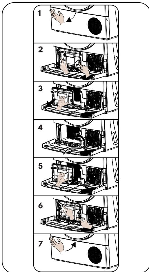
En cas de présence d'un objet étranger sous le compartiment du filtre, retirer le filtre, ouvrir le compartiment de l'échangeur de chaleur et retirer l'objet étranger. Veiller à ne pas toucher l'échangeur de chaleur avec les mains nues pour éviter les blessures.
