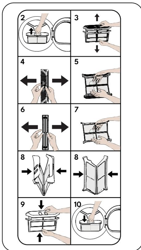
Après une longue utilisation du sèche-linge, si une couche bloquant la surface du filtre se forme, essuyer le filtre avec de l'eau tiède pour éliminer la couche. Avant de remettre le filtre en place, le sécher soigneusement.
