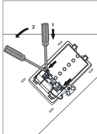
Anschlussdose öffnen: Zum Entriegeln Schraubendreher ansetzen (1) und geringfügig nach unten bewegen (2).
