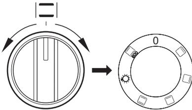
und des Temperaturreglers – die Wahl der gewünschten Backofentemperatur erfolgt durch Drehen auf den entsprechenden Temperaturwert.
