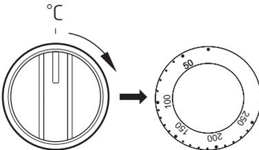
Beim Ausschalten des Geräts sind beide Schalter auf die „●/„0“-Position zu drehen.
