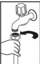
Verwenden Sie den Zulaufschlauch vom alten Geschirrspüler nicht. Verwenden Sie den neuen Zulaufschlauch, der zusammen mit dem Gerät geliefert wurde. Vor dem Anschließen spülen Sie den Zulaufschlauch von Innen mit Wasser aus. Schließen Sie den Zulaufschlauch direkt an einen Wasserhahn an. Der Wasserdruck in der Versorgungsanlage sollte mindestens 0,03 MPa und maximal 1 MPa betragen. Wenn der Wasserdruck 1 MPa übersteigt, muss vor dem Geschirrspüler ein Druckminderventil eingebaut werden.
