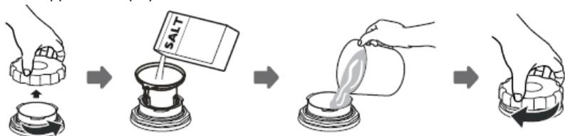
1. Retirer le panier inférieur et dévisser le couvercle du réservoir.
