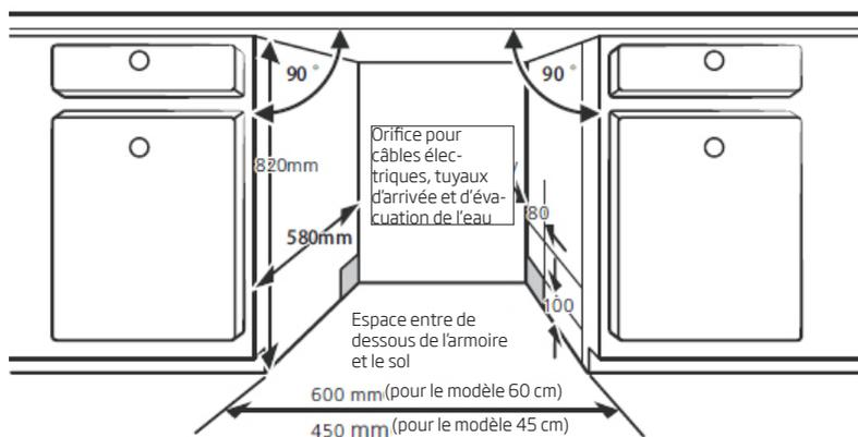
2. En installant le lave-vaisselle dans une armoire angulaire, laisser de la place pour l'ouverture de la porte.
