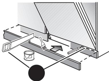
**ATTENTION :** En raison de la spécificité du meuble d'encastrement, il peut s'avérer nécessaire de couper un peu la baguette de la plinthe.
