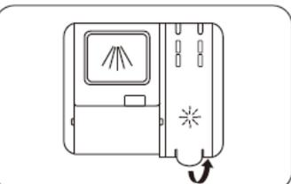
**1** 1. Öffnen Sie den Dosierer, indem Sie den Deckel mit dem Griff anheben.
