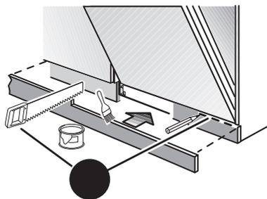
**HINWEIS:** Wegen der Bauweise des Umbauschranks muss möglicherweise die Sockelleiste entsprechend zugeschnitten werden.
