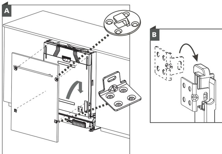
Nach dem Anziehen der Schrauben sollten zwei Gummistopfen in die Löcher gesteckt werden, um ein Einklemmen der Finger zu vermeiden.
