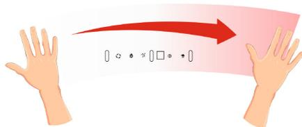
Ak chcete zapnúť ventilátor alebo zvýšiť jeho rýchlosť, v pohotovostnom režime niekoľkokrát pohnite rukou zľava doprava. Po každom geste ruky sa na displeji zobrazí aktuálna rýchlosť ventilátora.
