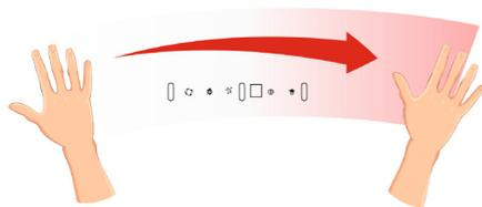
Chcete-li zapnout ventilátor nebo zvýšit rychlost ventilátoru, v pohotovostním režimu pohněte rukou zleva doprava. Po každém gestu ruky se na displeji zobrazí aktuální rychlost ventilátoru.
