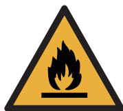
Danger; risque d'incendie/ matières inflammables
